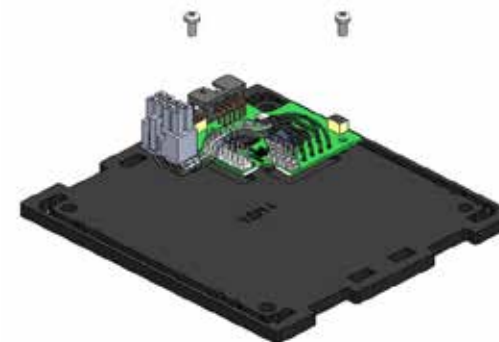
Рисунок 54. Установка платы УДМ
