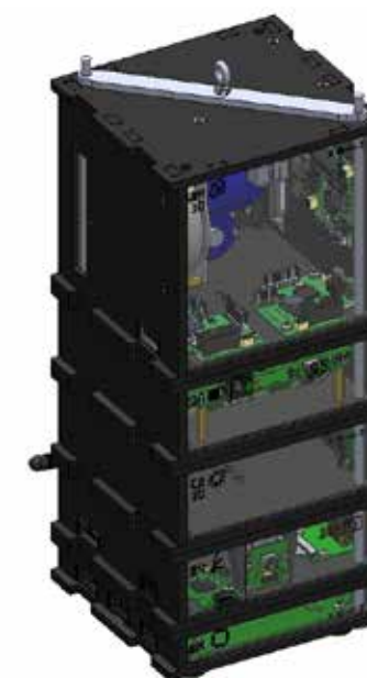
Рисунок 129. Установка винта с кольцом
