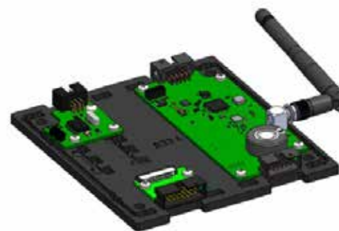
Рисунок 29. Установка платы ВЧ
