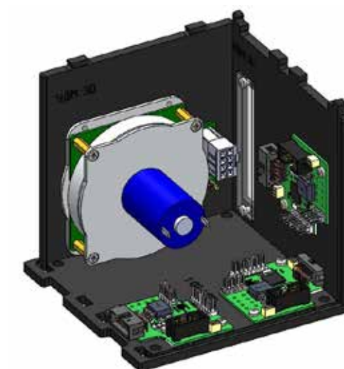
Рисунок 66. Установка боковой стенки на нижнее основание
