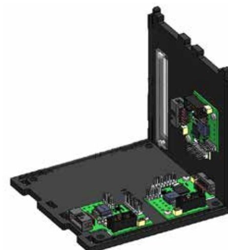
Рисунок 64. Установка боковой стенки на нижнее основание
