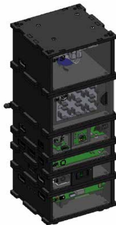
Рисунок 117. Установка модулей БВМ, УКВ+ВЧ+ДЗЗ, ПН и УДМ
