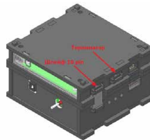
Рисунок 112. Терминирующий резистор (терминатор)
