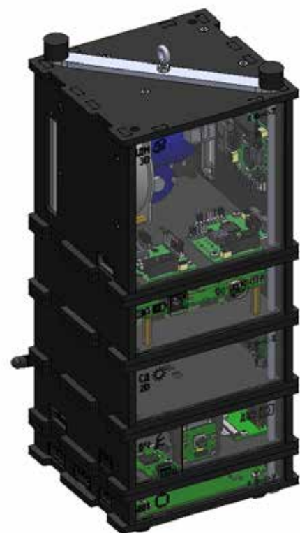
Рисунок 130. Крепление верхнего основания
